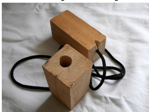
FLEURYFIX™, modèle « bois » : tasseau de base carrée ≈35mm environ, longueur ≈80mm, Perçage diamètre 12mm sur profondeur 70mm, perçage 5 mm de l'autre côté pour déboucher.
