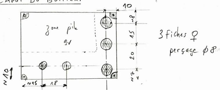
2 LEDs : perçages  $\phi 5$
