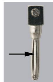
**Fils partiellement coupés** à l'intérieur des prises : les multiples tiraillements des fils entraînent des ruptures progressives des brins de cuivre, provoquant des touches « non-valables » intempestives.
