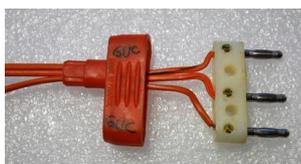
**Fil déconnecté du côté de la prise à 3 broches** : ces pannes sont dues à un arrachement accidentel : il faut démonter, recouper et rebrancher les fils sans les intervertir. Faire attention au sens de montage du capuchon.
