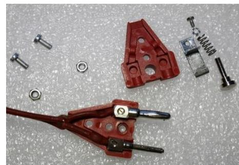
**Pince crocodile arrachée** : la reconnecter ! (vis ou soudure, selon les modèles)
